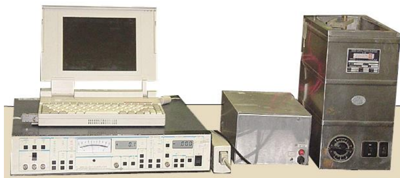
Figura 9 - Equipamento utilizado para realização de medidas de temperatura intrapulpar, composto de amplificador, conversor de sinais, banho térmico e computador para análise de dados.
