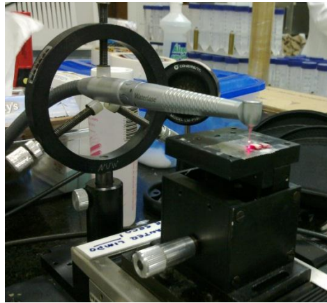
Figura29: Peça de mão do laser posicionada em suporte óptico para irradiação das amostras posicionadas sobre deslocador micrométrico automático.
