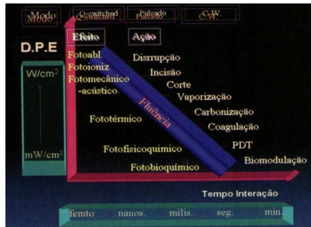
Figura 16: Efeitos Ocasionáveis no Tecido Biológico devido à Interação do Laser em relação à diferença de Densidade de Potência e Tempo.
