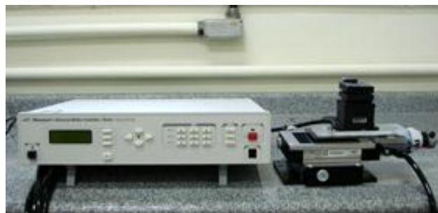
Figura 28: Deslocador micrométrico automático de passo X-Y-Z utilizado no presente estudo
