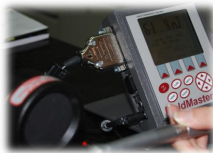
Figura 30: Aferição da energia por pulso com medidor de potência e energia.
