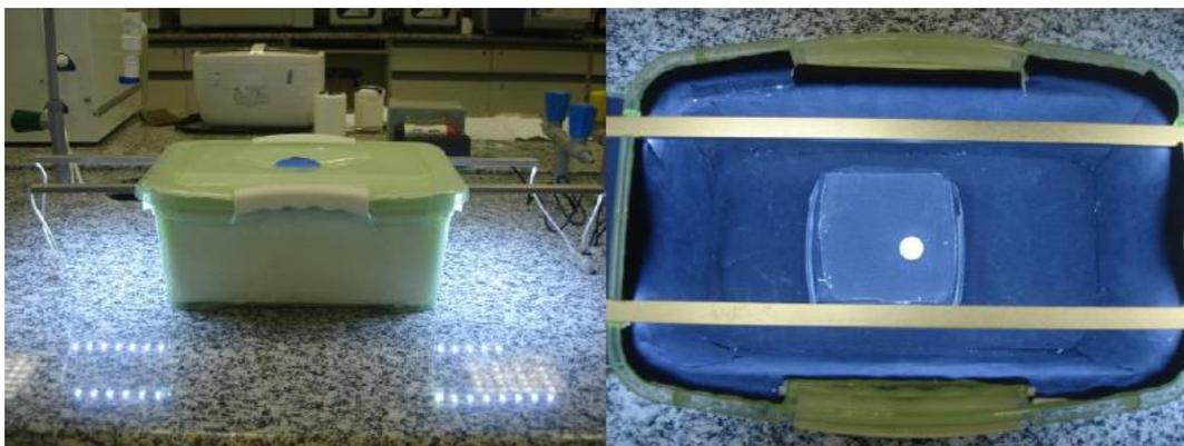
Figura 22: Montagem para obtenção das fotos das amostras [34].
