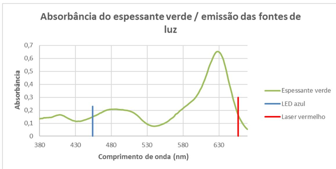
Figura 11: Comparação entre os comprimentos de absorção do espessante verde e pico de emissão das fontes de luz utilizadas.
