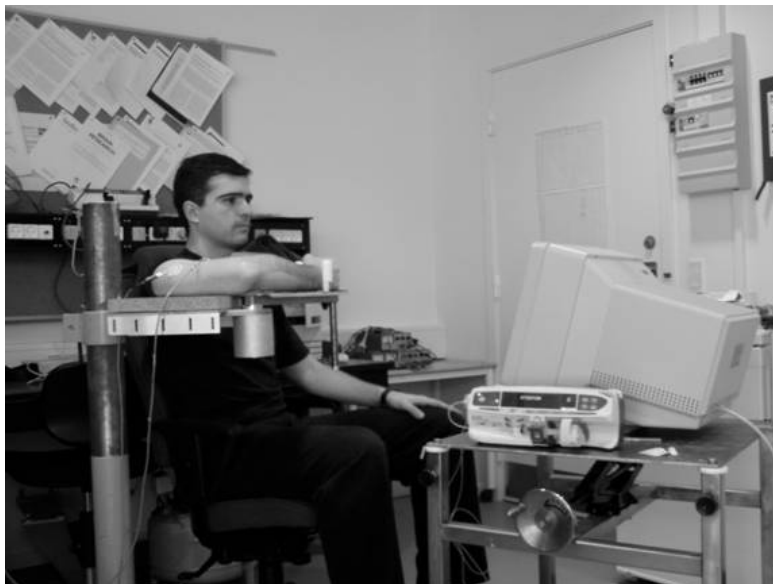
FIGURA 2 - Aparato experimental. A tela do osciloscópio é posicionada em frente ao sujeito para facilitar a visualização da intensidade do sinal EMG e da força gerada. Braço e antebraço são suportados pelo manipulandum . O ombro é posicionado a 90° de abdução e 45° de flexão horizontal. A articulação do cotovelo fica alinhada com o fulcro do manipulandum . A injeção intramuscular de solução salina hipertônica é controlada por uma bomba infusora (ALARIS medical systems, Aseña, UK).
