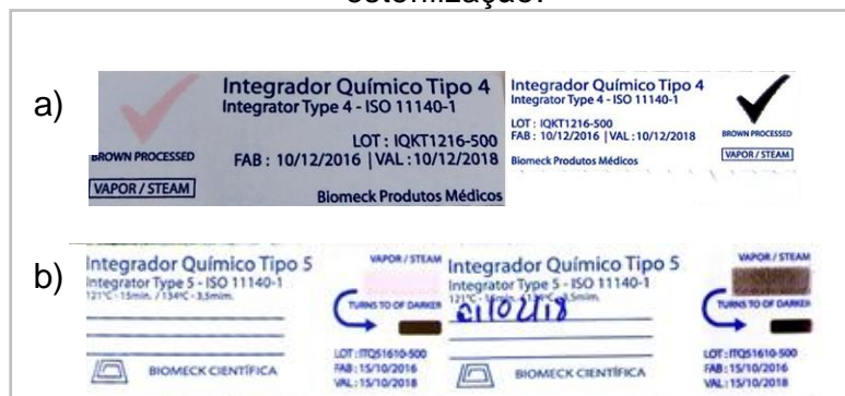
Figura 18 – Indicadores químicos tipos 4 e 5 utilizados antes e após o ciclo de esterilização.
