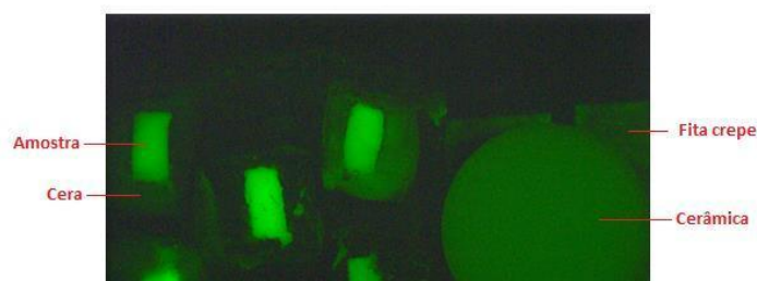
Figura 26: Representação de uma imagem obtida pelo Sistema de Imagens por Fluorescência (SIF), com indicação do que se refere a amostra, cera, cerâmica e fita crepe.
