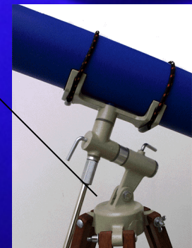
Montagem equatorial- rotação para acompanhar a rotação dos astros
